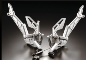
アルミ削り出しバックステップKIT タンデムステー付き ¥92,400 4ポジション 15mm/20mmBACK 50mm/60mmUP ※油圧ストップランプスイッチ付属 ※プラス¥5,000でカラーオーダー承ります。 ※ナイフエッジベダル採用
